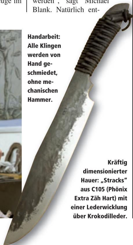
**Kräftig dimensionierter Hauer: „Stracks“ aus C105 (Phönix Extra Zäh Hart) mit einer Lederwicklung über Krokodilleder.**
