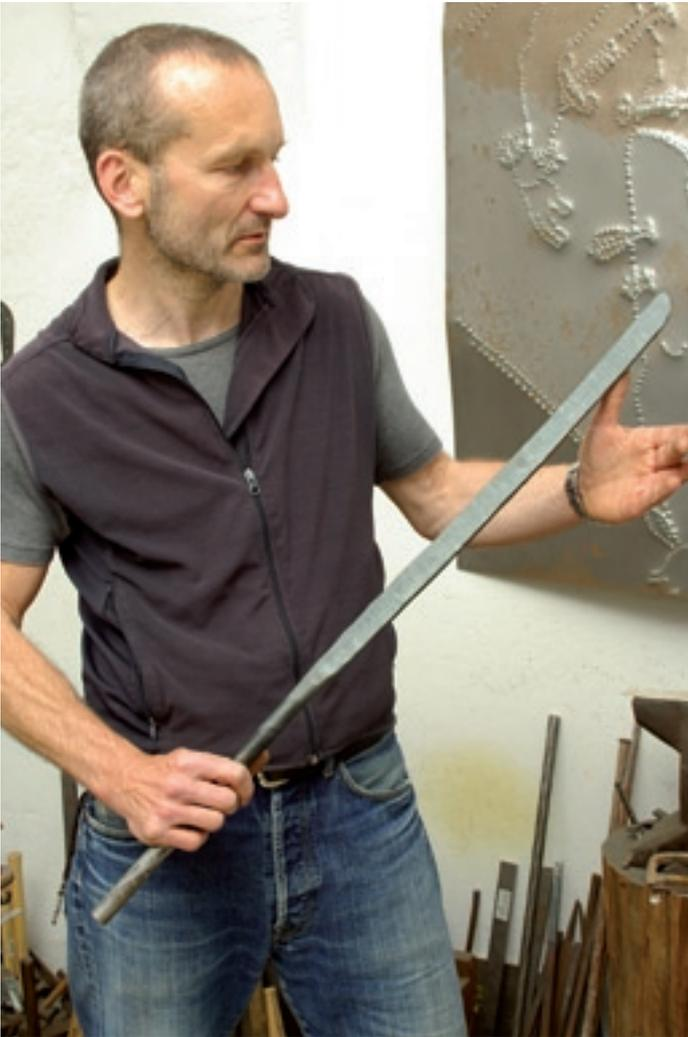
Rohmaterial: Michael Blank mit einer Stange K990-Werkzeugstahl (entspricht W1). Er schmiedet das Rundmaterial flach aus.
